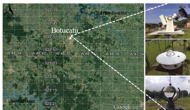
Figura 1: Local e dados utilizados. a) localização da estação, b) Pireliômetro, c) Piranômetro e d) Heliógrafo.
