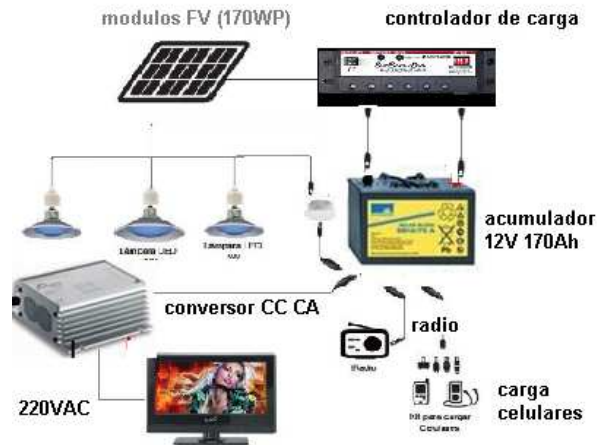
Figura 8 Descripción sintética de una instalación FV del PERMER
