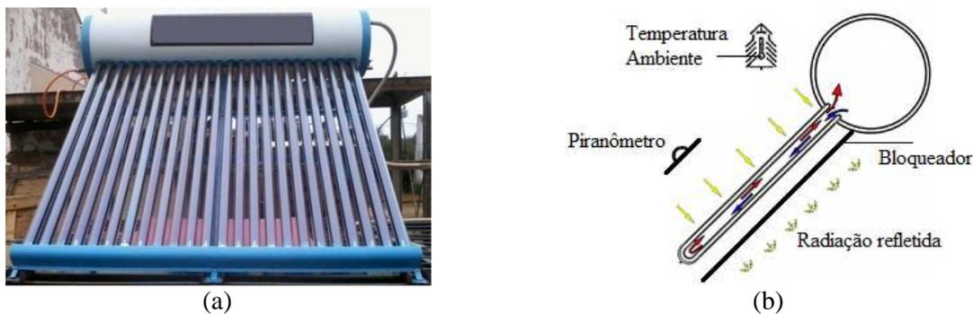
Figura 5: Coletor solar de tubos evacuados utilizado para os ensaios: (a) fotografia do coletor instalado; (b) desenho esquemático da bancada de ensaio.
