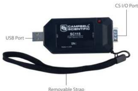
Figura 15 Módulo SC115 de 2GB, utilizado con el logger CR850
