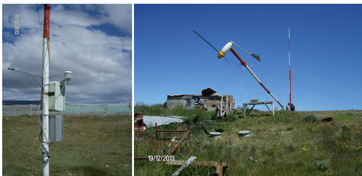
Figura 4 – Zona alta: Estación Nomad2 ( izq), y Montaje aerogenerador Bergey XL.1 24 VCC (der)
